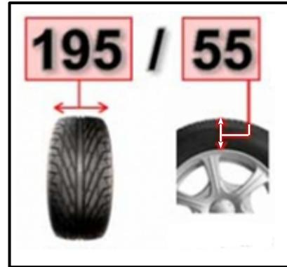
Considere um veículo que teve os seus pneus, de especificações 215/60, trocados por outros, de especificações 205/40. Nessas condições, a altura do veículo em relação ao solo foi alterada em quantos centímetros?
