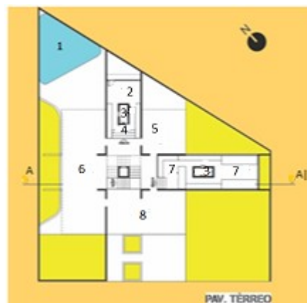
Planta Baixa Pavimento Térreo (FONSECA, Ronaldo da Paixão. Caminhos de uma arquitetura /Obra e trajetória de Antônio Lúcio Ferrari Pinheiro)
